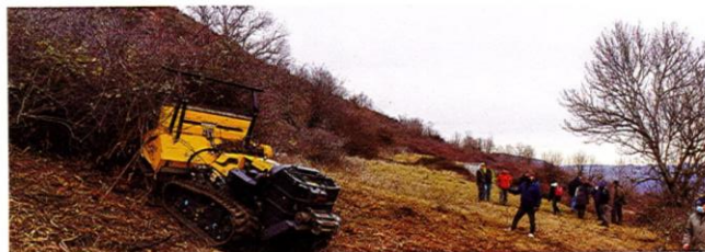
Nettoyage d'un terrain très embroussaillé au moyen d'un tracteur débroussaillier télécommandé
